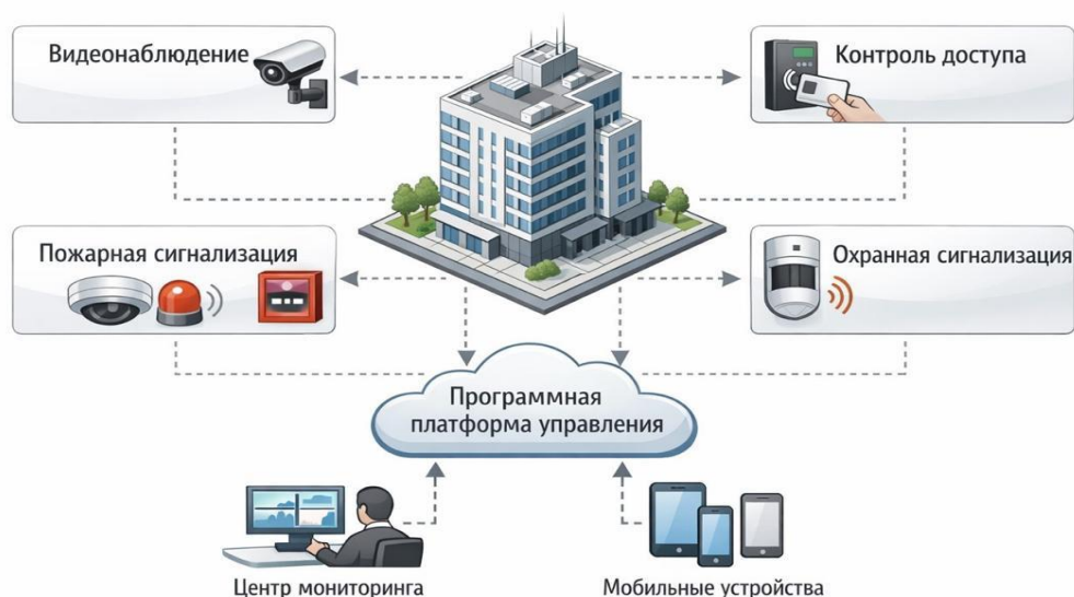
Рис.1. Структурная схема программно-интегрированной системы безопасности здания
